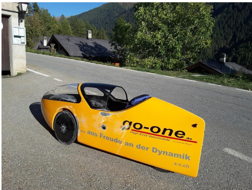
Nach 200 m Rutschen auf dem Asphalt
