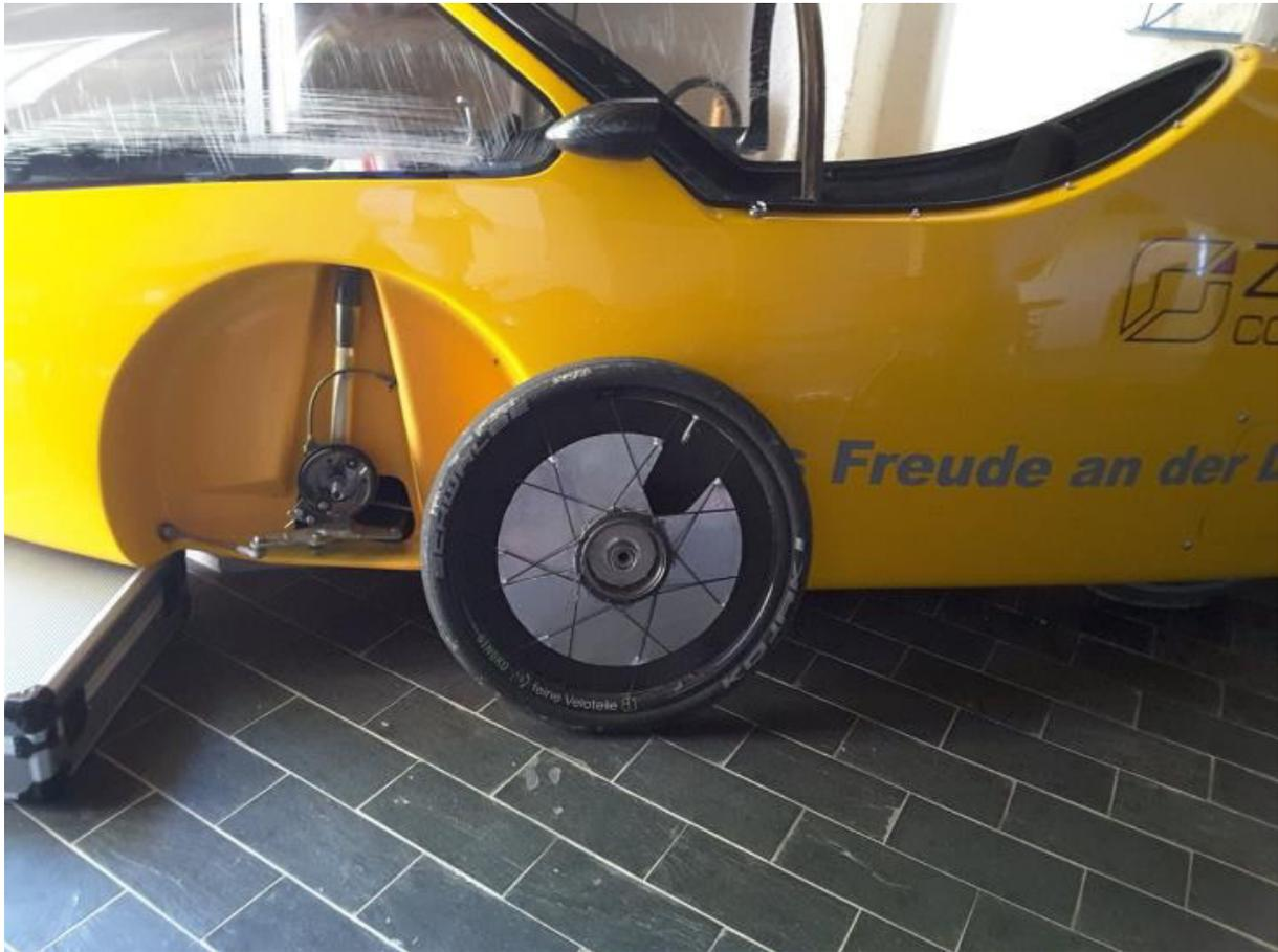
*Das sind keine Scheibenbremsen sondern Bremsscheiben (zum Ableiten der Wärme).*
